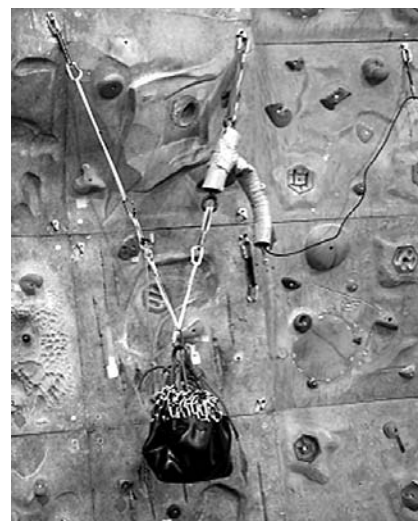
図2 アンカーに掛かる荷重の測定
