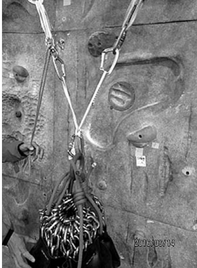
図3 クローブヒッチで固定分散したアンカーで片方の支点を除荷する直前
