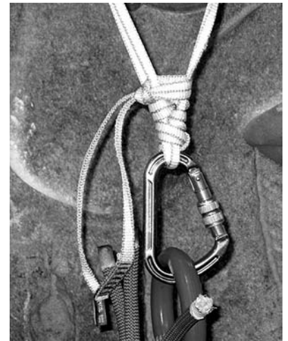
図4 流動分散式に連結した上から別の一方が脱落したスリングで締め込んだ様子
