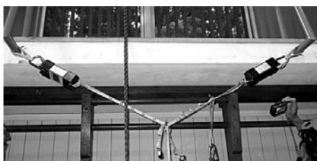
図5 異なる開き角度のアンカーにおいて各支点を引く張力を計測 (左右の荷重計にて張力を測定)
